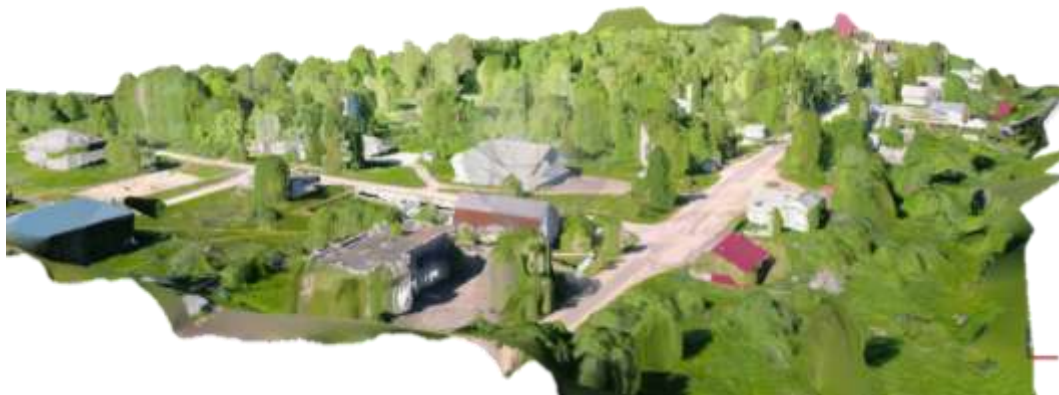
Рис. 3. Цифровая модель местности, разработанная на основе аэрофотосъемочных данных, полученных цифровой неметрической камерой среднего разрешения
