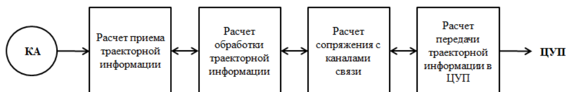
Рис. 2. Вариант состава слаживаемых расчетов при выполнении задачи приема, предварительной обработки и передачи траекторной информации в центр управления полетом (ЦУП КА)
