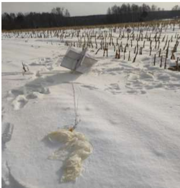
Рис. 1. Радиозондовая оболочка с радиолокационными уголковыми отражателями (Донецкая область, февраль 2023 г.)
